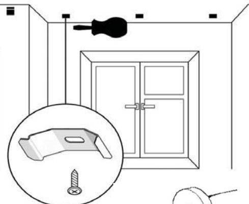
6. В случае использования металлических кронштейнов крышки кронштейна одеваются по бокам кронштейнов
