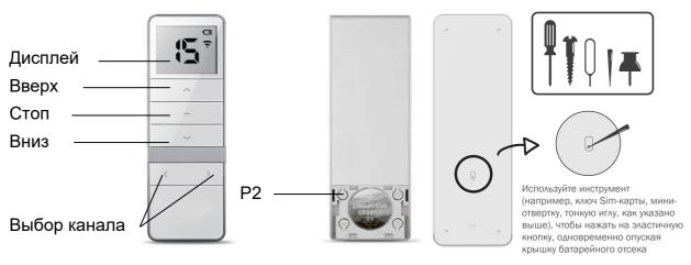
Пульт DD1802P служит для управления приводами Amigo как обычными, так и с обратной связью. Использование режима с обратной связью даёт ряд дополнительных преимуществ, таких как повышенная помехоустойчивость и быстрый отклик на команду из-за улучшенной кодировки сигнала.
