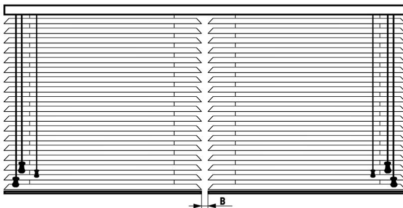
Изделие с двумя полотнами и независимым управлением на одном карнизе рекомендуется в случаях, когда два отдельных изделия установить невозможно или крайне затруднительно. Стандартный зазор В между полотнами – 0,5...1,0 см.
