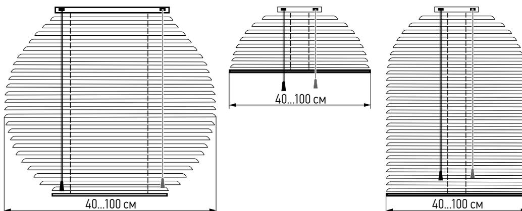
Модели предназначены для закрытия проемов окон круглой, полукруглой и совмещенной формы из полукруга и прямоугольника. Ширина верхнего карниза рассчитывается автоматически при изготовлении и составляет как правило около 20 см. При установке внутрь проема изделия работают только на поворот ламелей или на подъем только до точки с самой большой шириной. Боковая фиксация не предусмотрена. Шнур и прут управления располагаются всегда с разных сторон.
