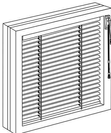
Межрамные жалюзи - это горизонтальные модели жалюзи с поворотными ламелями, предназначенные для установки между стеклами офисных перегородок.
