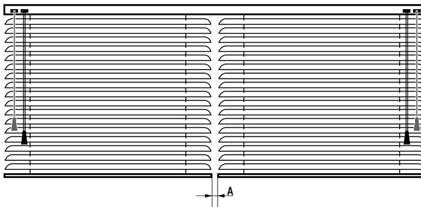
Изделие с двумя полотнами и независимым или единым управлением на одном карнизе рекомендуется в случаях, когда два отдельных изделия установить невозможно или крайне затруднительно. Стандартный зазор А между полотнами – 0,5...1,0 см. Размеры каждой секции могут быть любыми.
