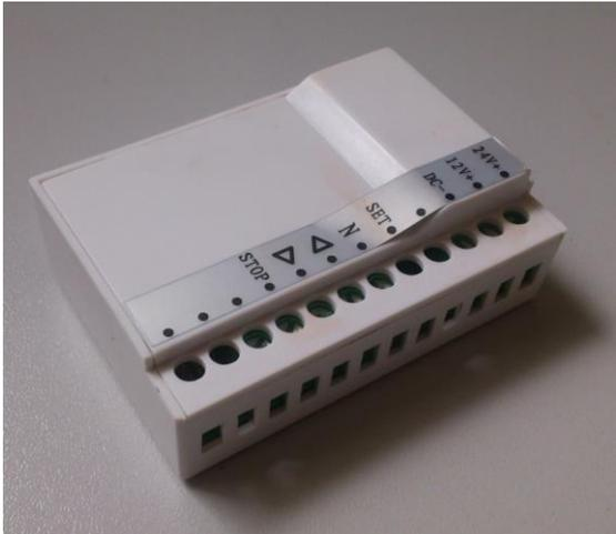
*Радиопередатчик DD1149P служит для управления всеми типами радиоустройств Amigo, работающих как по обычному протоколу, так и по протоколу с обратной связью, посредством команд системы централизованного управления («Умного дома» и пр.) по «сухим» контактам. Использование режима с обратной связью даёт ряд дополнительных преимуществ, таких как повышенная помехоустойчивость и быстрый отклик на команду из-за улучшенной кодировки сигнала.*
